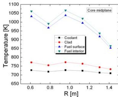
Fig. 4 Radial temperature distribution (CERMET)
