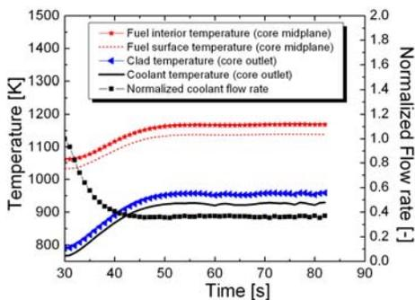
Fig. 10 Temperature and Pb flow rate transient (CERMET)
