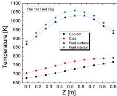
Fig. 3 Axial temperature distribution (CERMET)
