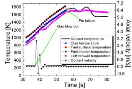
Fig. 15 Temperature development in an UBA (CERMET)
