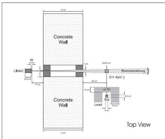
Fig. 3. MCNPX geometry for bremsstrahlung
