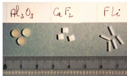
Figure 7 : Thermo Luminescent Dosimeters
